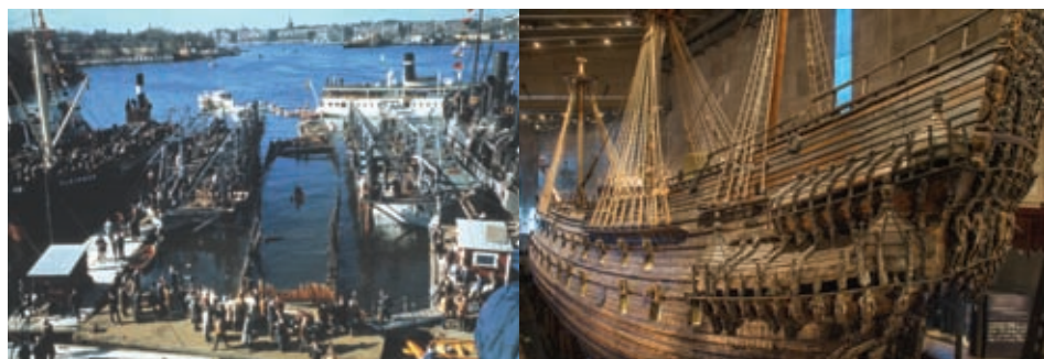
Figura 6. Vista a la izquierda de cómo el Vasa rompe la superficie del agua después de 333 años bajo el mar báltico con la ayuda de los pontones de rescate Oden y Frigg en 1961. La conservación comenzó después de la excavación. El barco fue rociado e impregnado con polietilenglicol (PEG) durante 17 años. Desde 1990, el barco ha estado en exhibición en el Museo Vasa. Crédito: Museo Vasa.
